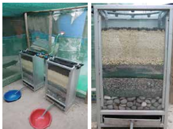
Figura 1. Vista general del sistema de tratamiento (izquierda); estratos conformantes de cada lombrifiltro (derecha).
