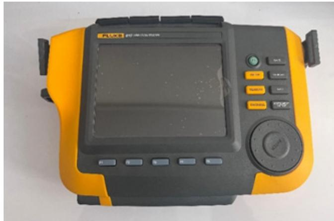
Fluke (2018), el analizador de Vibraciones FLUKE modelo 810 es un instrumento avanzado para la predicción de mantenimiento. Mide y analiza la vibración de la maquinaria industrial para encontrar problemas como fallas de rodamientos, desalineación y desequilibrio. Realiza diagnósticos
