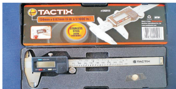
Figura 4. Calibrador digital marca TACTIX serie 245111. Rango de medición: 0-150mm / 0-6", 0-200 mm / 0-8" 0-300 mm / 0-12". Resolución: 0,01 mm / 0,0005"
